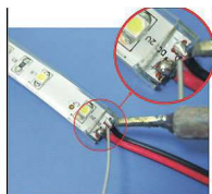
2. rimozione silicone dai pads e saldatura fili sui pads + e -
