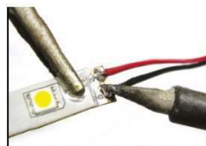
3. saldatura fili sui pads + e -
