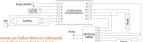
Collegamento con ballast elettronico bilampada Electronic ballast connection twin lamp
