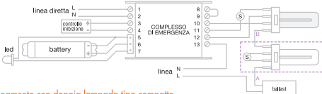
Funzionamento con doppia lampada tipo compatto Compact type double lamp operation
